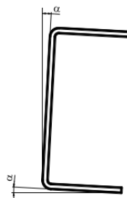
pav. 1 Profilio sraigtiškumo matavimas.
