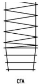
pav. 5 CFA polio galo armavimas
